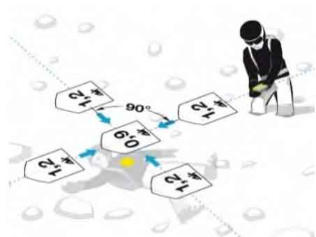
Mueva su baliza a una velocidad lenta y constante de unos 10 cm/s; mantenga nivelada la baliza cerca de la superficie y no gire el dispositivo. Busque a lo largo del eje Y; determine el valor de distancia más bajo y siga a lo largo del eje X. Muévase siempre pasando por el punto con la distancia más baja para verificar la
