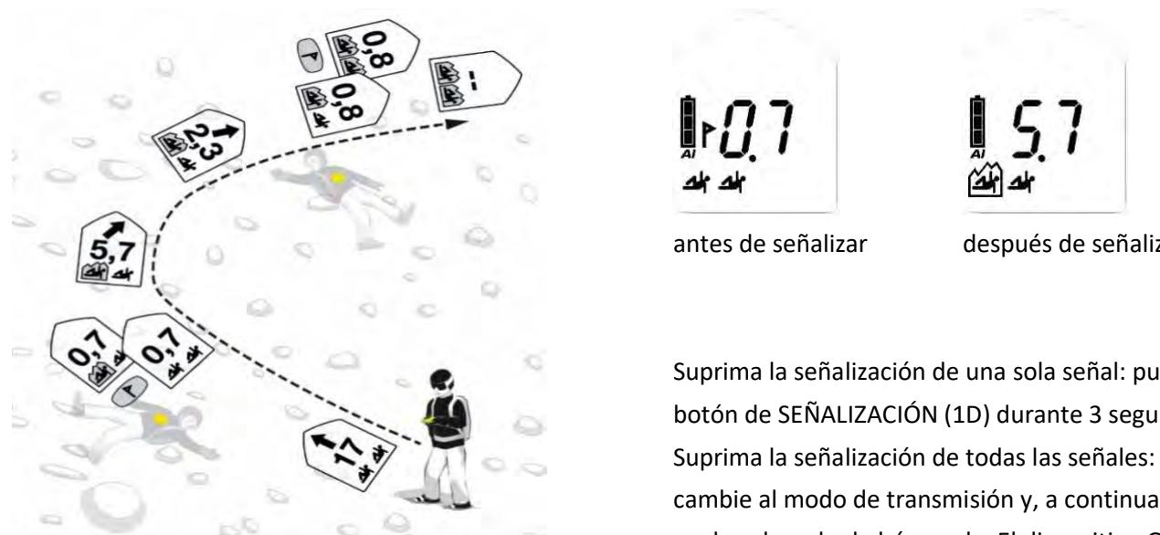
Suprima la señalización de una sola señal: pulse el botón de SEÑALIZACIÓN (1D) durante 3 segundos.
