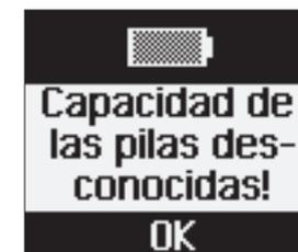
Si usted ha colocado pilas alcalinas y de litio al mismo tiempo o trata de usar pilas de litio que ya han sido usadas en otro aparato, la capacidad de la pila no podrá ser definida.
