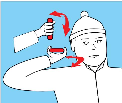
Para optimizar la recepción de la señal, rotar lentamente el dispositivo en todos los ejes. Para ello sostenga el aparato con el parlante al lado de la cabeza, cerca a la oreja.
